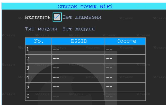
Вы можете ввести значение ESSID точки доступа Wi-Fi вручную, или можете нажать кнопку «Поиск» для поиска доступных точек доступа Wi-Fi.
